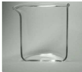
vue de la coupe du bécher remarquez l'épaisseur des parois, leur régularité et la finition générale
