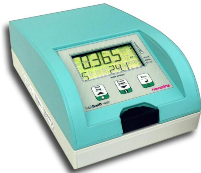
L'instrument *LabSwift-a<sub>w</sub>* intègre une carte SD permettant le stockage des analyses effectuées.
