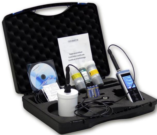
Le ClimMate-set  $a_w$  est un appareil économique principalement destiné à des mesures sur lignes ou nécessitant un transport facilité. Il est alimenté par piles et est équipé d'une grande chambre de mesure. Sa précision peut être contrôlée à tout moment grâce à nos standards étalons de type SAL-SC.
