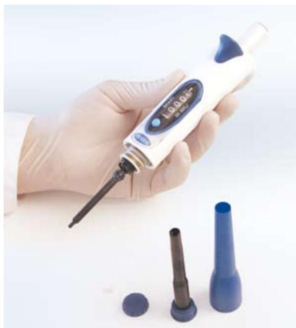
La pipette mLINE a été conçue pour une maintenance simple et économique, aucun outil d'ouverture n'est nécessaire. Il suffit de nettoyer seulement 3 ou 4 pièces et de graisser le piston.
