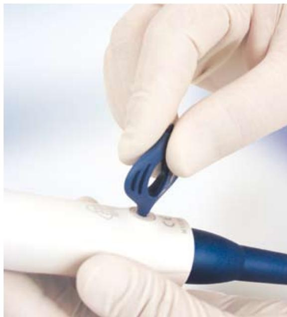
La pipette mLINE peut être facilement réglée avec la clé de calibrage fournie.
